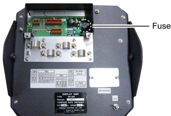
*Posizione del fusibile (pannello posteriore con coperchio dei cavi rimosso)*
